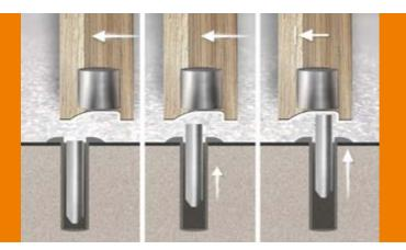
O conjunto é composto por 2 partes. Um cilindro de neodímio embutido na **porta** e um pino metálico embutido no piso. O alto poder magnético do neodímio faz o pino levantar e encaixar na placa de nylon que está fixa na porta, travando a porta no momento em que é aberta.
